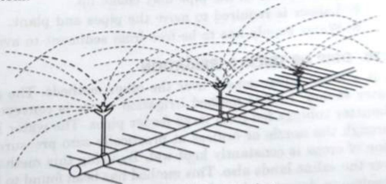
Fig. 8.8. Sprinkler Irrigation
